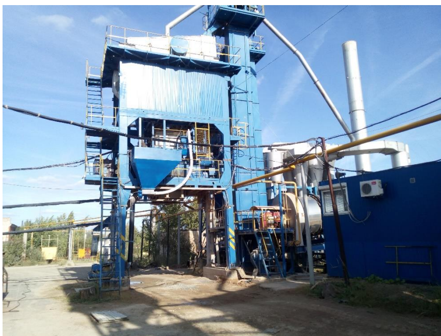
Агрегат целлюлозной добавки. Подача ЦД в асфальтосмеситель в центр между валами 3 сек для равномерного распределения. Заправка бункера на 600 тн. асфальта тельфером 1 тн. из транс- портного средства.
